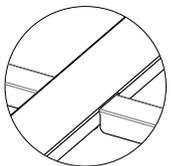
7° Com a prateleira (PRA) enclinada encaixe-a na coluna e nas laterais, após encaixada parafuse-a nas costas (FU).
